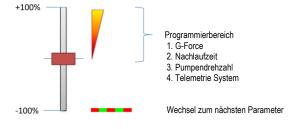
Für die schnelle Programmierung (auch einzelner Parameter) kann ein Windows-PC, ein Tablet oder ein Handy verwendet werden. Das benötigte USB-Kabel und der BlueCom-Adapter bieten wir als optionales Zubehör an. Die Software steht zum Download bereit.
